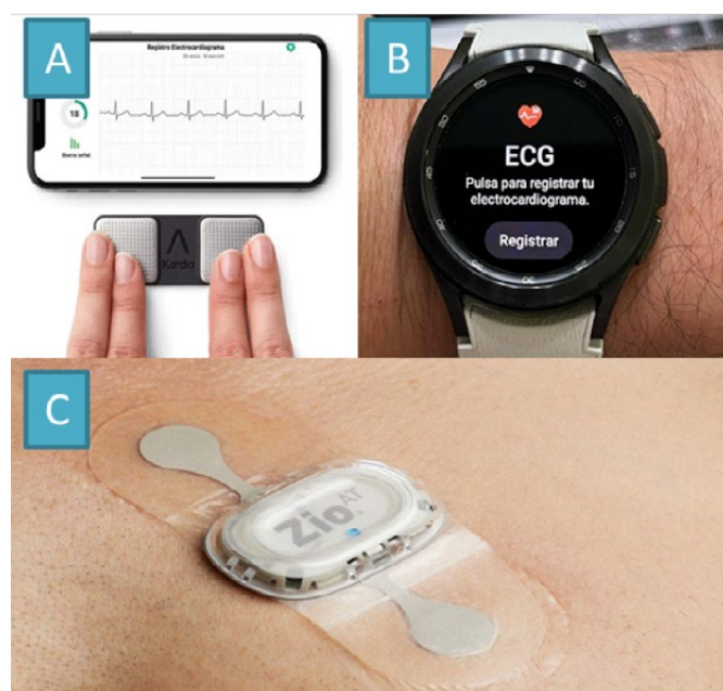
FIGURA 1. Dispositivos digitales. (A) Registrador de eventos de una derivación. (B) Reloj inteligente con sensor eléctrico para ECG de una derivación. (C) Parche para monitoreo continuo.
