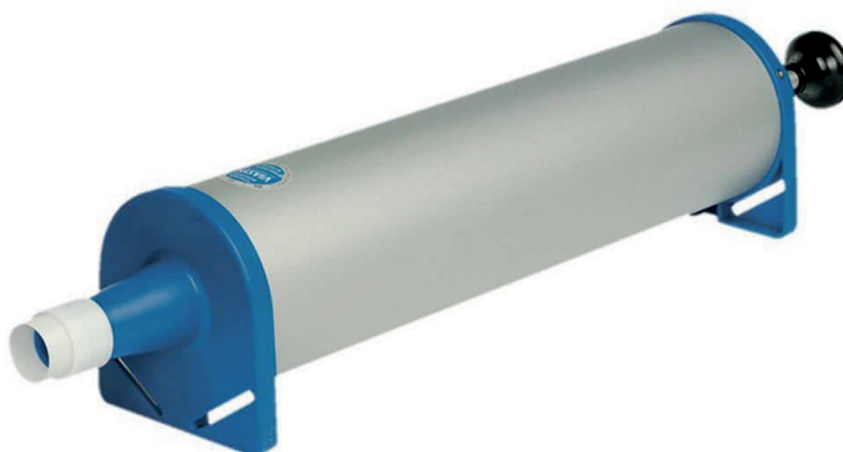
Fig. 2. Jeringa de 3 litros de calibración.
