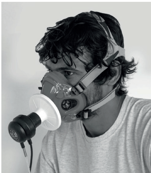
Foto 6. Filtro adosado entre la máscara y el neumotacógrafo
