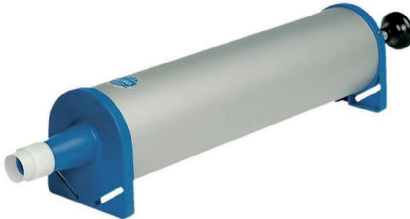
**Fig. 2.** Jeringa de 3 litros de calibración.
